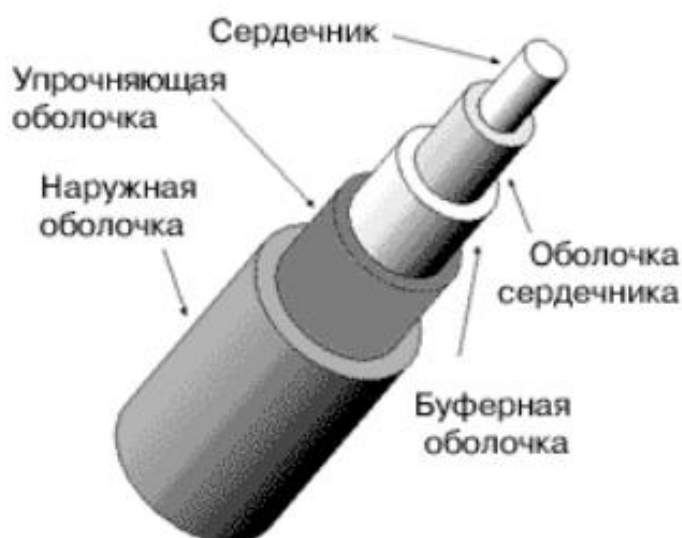
Рисунок 1.5 - Структура кабеля с плотным буфером
